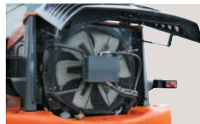
La velocità della ventola può essere regolata in base alla temperatura del fluido, per raffreddare efficacemente refrigerante, olio idraulico, olio della trasmissione e olio del convertitore di coppia. Il risultato è una maggiore durata di servizio dei componenti e un minore consumo di combustibile. Per agevolarne la manutenzione, la ventola è separata dal motore.
