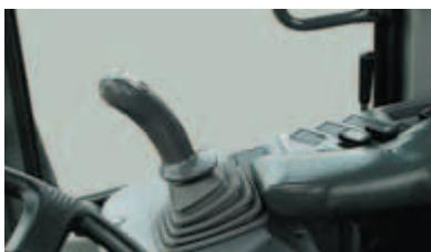
La leva joystick multifunzione è posizionata in cima alla leva di controllo per agevolare le manovre.
