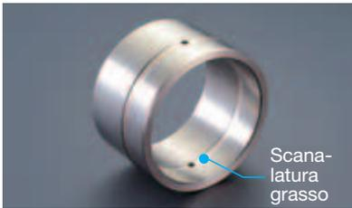
La nuova boccola HN con olio ad alta viscosità è presente presso ogni giuntura per ridurre il consumo di grasso, prolungare gli intervalli di lubrificazione (da 100 a 500 ore) e aumentare la durabilità.
