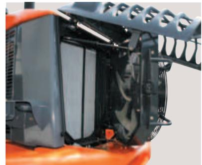
La rotazione della ventola di raffreddamento ad azionamento idraulico con sistema di rilevamento del calore può essere invertita per facilitare la rimozione della sporcizia dal radiatore. Anche la ventola può essere aperta per agevolare la pulizia.
