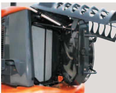
Per proteggerli dalla corrosione, i radiatori di acqua e olio sono realizzati in alluminio, invece che nel tradizionale acciaio o rame.
