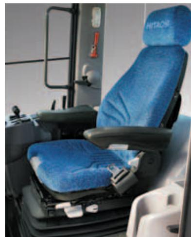
Il sedile a sospensione pneumatica consente molteplici regolazioni: peso-altezza, posizione avanzata-arretrata e angolazione dei braccioli, lunghezza e angolazione del cuscino del sedile, altezza e angolazione del poggiatesta e supporto lombare. Il riscaldatore del sedile è montato di serie.
