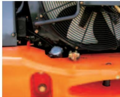
Il bocchettone di rifornimento del combustibile consente di fare rifornimento da terra.
