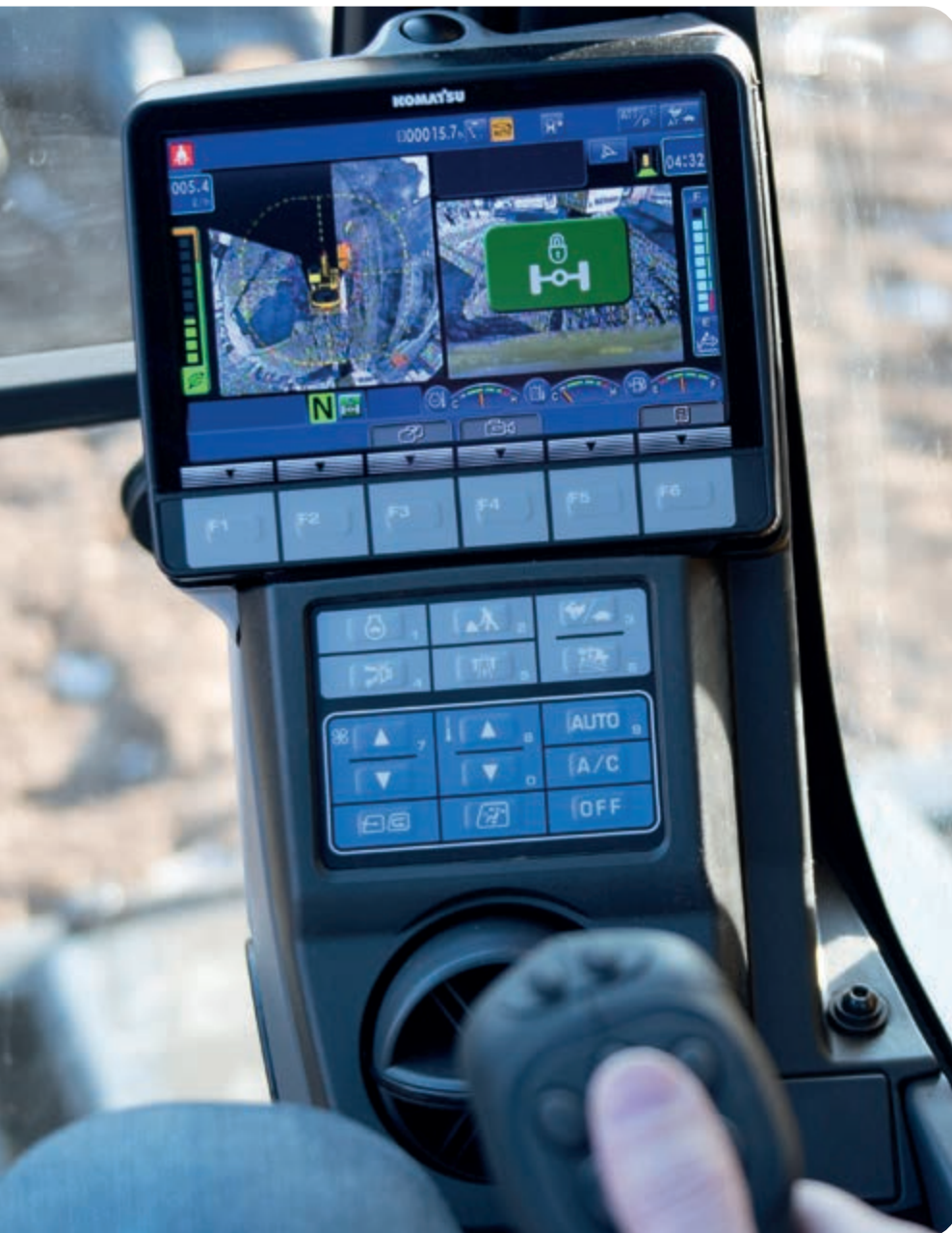
Utrustad med universella ledningar för redskap så som hammare, övergång till lågt tryck kräver endast ett tryck på hammarlägets strömställare på instrumentpanelen.
